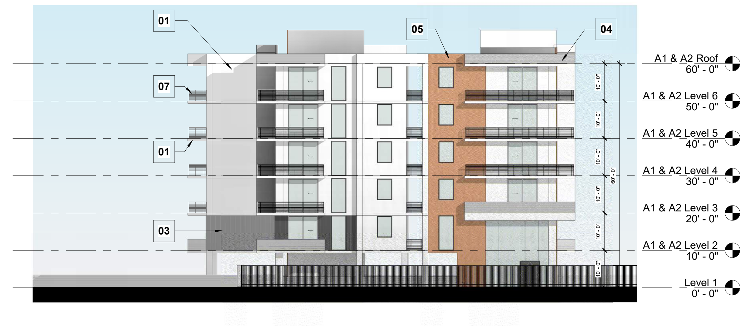
1 BLDG A1 - EAST ELEVATION A3.01 SCALE: 1/16" = 1'-0"
