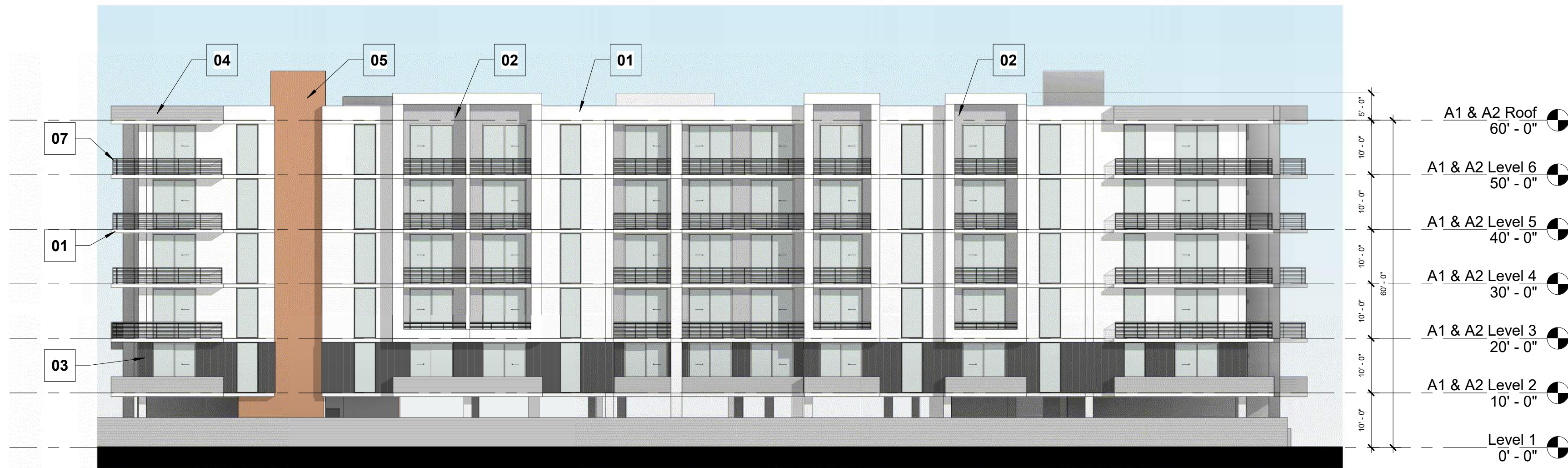
2 BLDG A2 - NORTH ELEVATION A3.02 SCALE: 1/16" = 1'-0"
